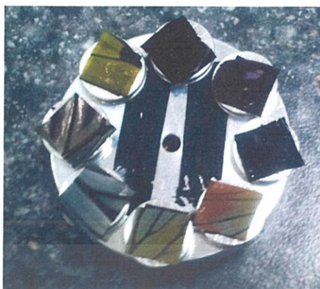
รูปที่ 3.7 รูปปึกผีเสื้อที่ coat ทองแล้วก่อนนำเข้าเครื่อง SEM
