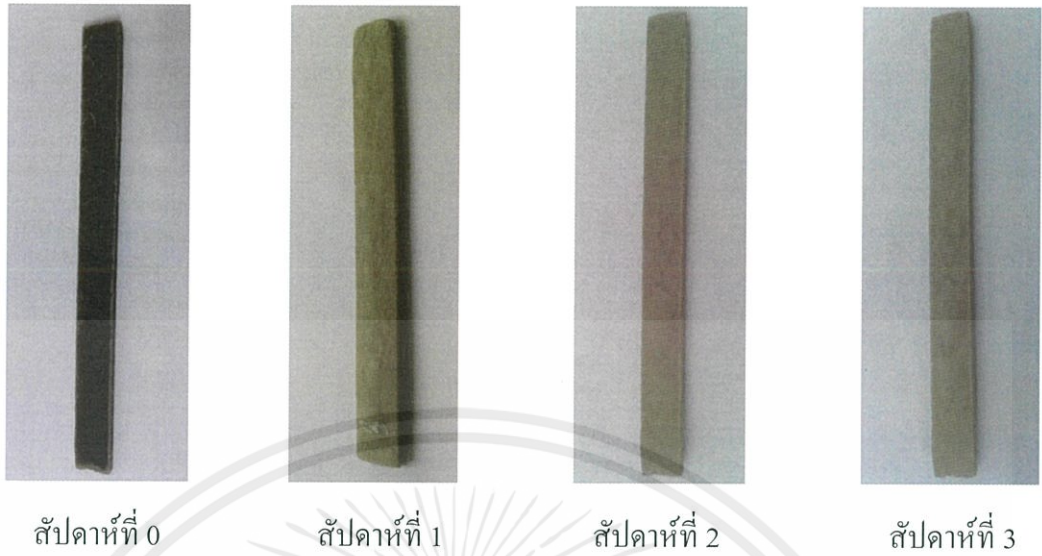
รูปที่ 4.9 การดูดซับน้ำของพอลิเมอร์ผสมระหว่าง TPAS/LDPE ที่ปรับปรุงด้วยเส้นใยฝ้าย 20 เปอร์เซ็นต์ โดยน้ำหนักของแป้ง
