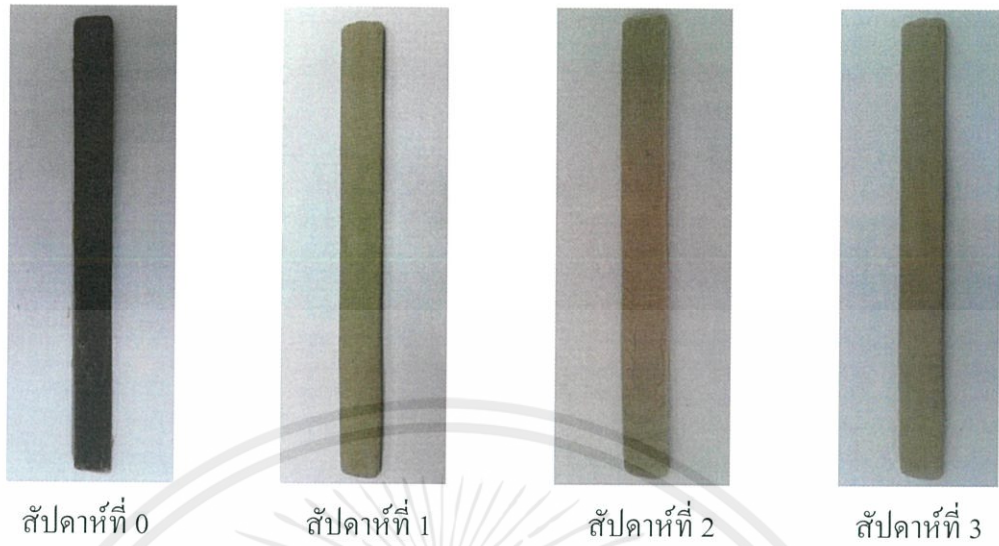
รูปที่ 4.11 การดูดซับน้ำของพอลิเมอร์ผสมระหว่าง TPAS/LDPE ที่ปรับปรุงด้วยเส้นใยนุ่น 20 เปอร์เซ็นต์ โดยน้ำหนักของแป้ง
