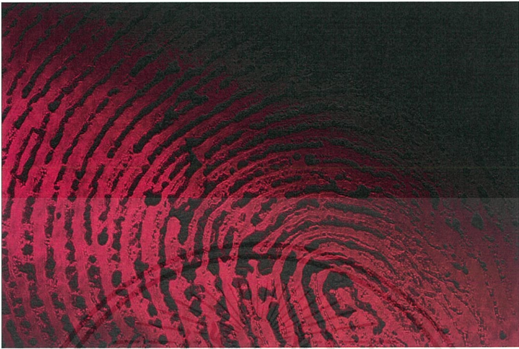
รูปที่ 4.30 แสดงภาพของวัตถุ (ลายนิ้วมือ) ซึ่งถ่ายด้วยวิธีของ Digital Holography โดยมีการกรองแนวลำแสงอ้างอิงด้วยกระดาษไข
