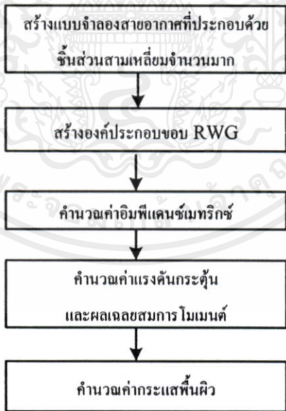
รูปที่ 5.2 บล็อกไดอะแกรมอัลกอริทึมการคำนวณสายอากาศด้วยระเบียบวิธีโมเมนต์
