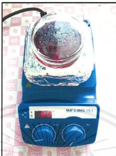
รูปที่ 3.5 การเชื่อมกระแสที่ผ่านการเคลือบฟิล์ม \text{TiO}_2 ในสีย้อม N719
