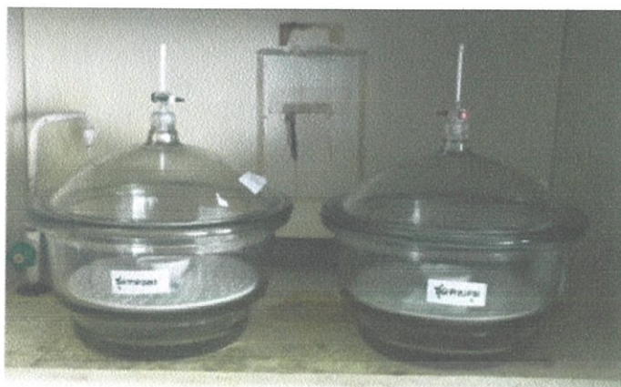
รูปที่ 3.1 การสร้างสภาวะบรรยากาศจำลองภายในเคชิกเคเตอร์ให้มีก๊าซฟอร์มัลดีไฮด์
