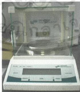
รูปที่ 2.13 เครื่องชั่งสารแบบละเอียดทศนิยม 3 ตำแหน่ง
