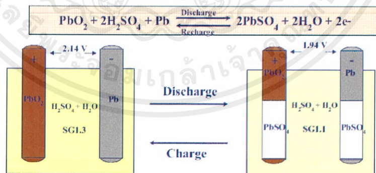
รูปที่ 2.10 ปฏิกริยาขณะคายประจุ และประจุ ของแบตเตอรี่ตะกั่ว-กรด[8]
