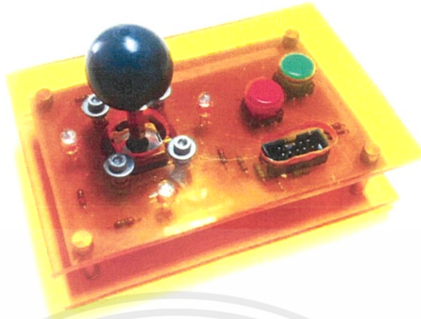
รูปที่ 3.5 กล่องควบคุม Joybox ที่ใช้ในการควบคุมการเคลื่อนของแท่นเลื่อน X-Y
