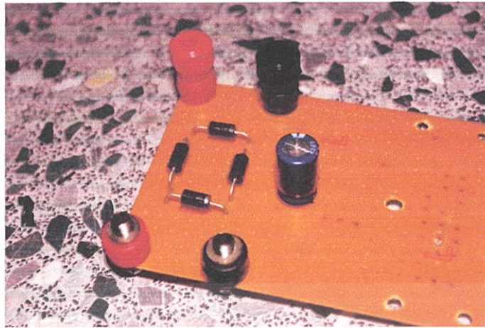
รูปที่ 5.8 วงจรทำกระแสตรงแบบบริดจ์ที่ใช้งานจริง
