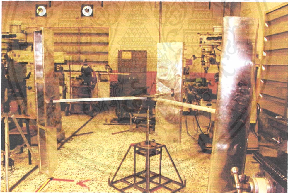
รูปที่ 4.9 ทำการเปลี่ยนแกนส่งกำลังหลักจาก 60 cm เป็น 100 cm
