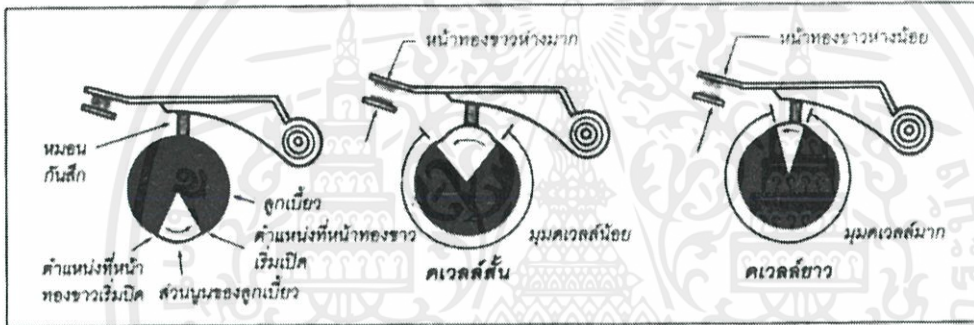
รูปที่ 2.18 แสดงความสัมพันธ์ของการจัดตั้งความห่างระหว่างหน้าทองขาวกับมุมคเวล์
