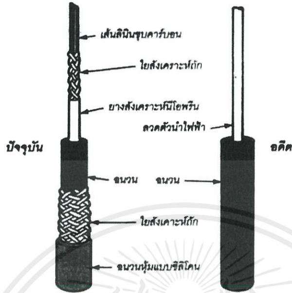
รูปที่ 2.12 เปรียบเทียบสายไฟแรงสูงที่ใช้กันในปัจจุบันกับในอดีต
