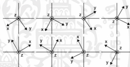
รูปที่ 6 ตำแหน่งต่างๆ ในการเก็บข้อมูลที่แนะนำสำหรับการปรับเทียบตัวรับรู้ความเร่ง (หมุนรอบแกน z)
