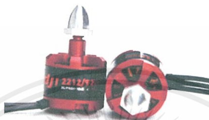
รูปที่ 2.15 มอเตอร์ Brushless ของ DJI INNOVATION
