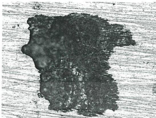
รูปที่ 4.3 พื้นที่ผิวชิ้นงานหลังทดสอบการกัดกร่อนในสารละลายกรดไฮโดรคลอริก เข้มข้น 0.005 โมลาร์ โดยไม่เติมสารสกัด กำลังขยาย 100 เท่า
