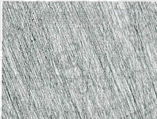
รูปที่ 4.2 พื้นผิวชิ้นงานหลังขัดกระดาษทราย กำลังขยาย 100 เท่า
