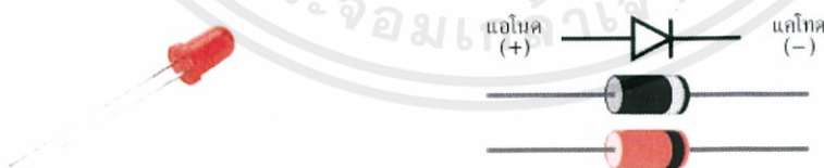
รูปที่ 2.12 LED ไดโอดเปล่งแสง
