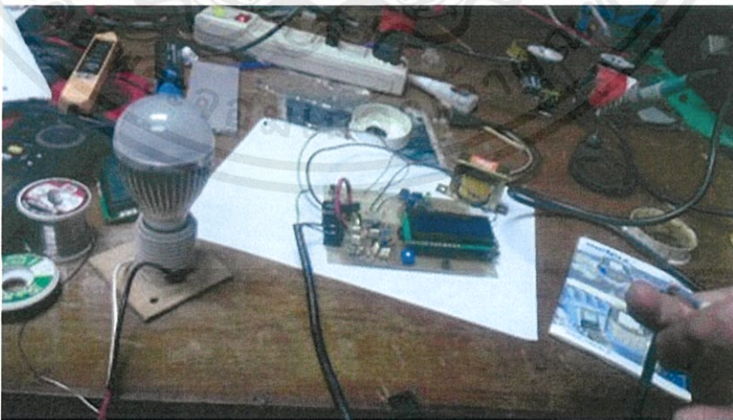
รูปที่ 4.2 เครื่องใช้ไฟฟ้าต่อกับเครื่อง energy meter
