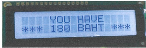
รูปที่ 4.18 LCD แสดงยอดเงินคงเหลือ
