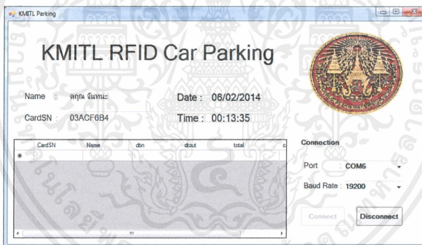
รูปที่ 4.19 หน้าต่างโปรแกรมฝั่งขาเข้าเมื่อเครื่องอ่าน RFID จับสัญญาณแท็กได้
