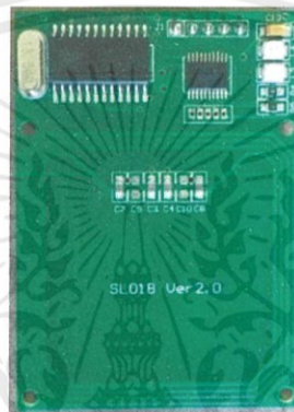
รูปที่ 3.2 RFID 13.56 MHz Read/Write Mifare Module (I2C)
