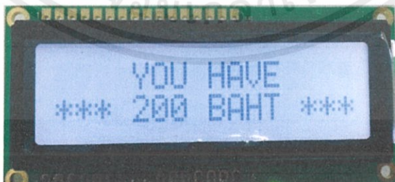
รูปที่ 4.13 LCD แสดงยอดเงินคงเหลือ
