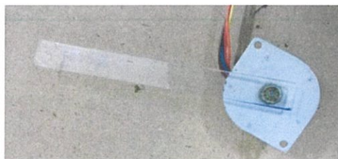
รูปที่ 4.27 เฟส 2 ของสเต็ปปีง มอเตอร์ ถูกกระตุ้นทำให้สเต็ปปีง มอเตอร์หมุนขึ้นอีก 7.5°
