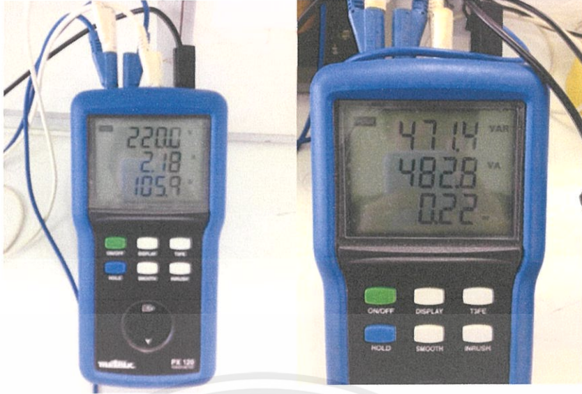
รูปที่ 4.9 ผลการทดลองที่วัดได้ขณะไม่มีการต่อตัวเก็บประจุ
