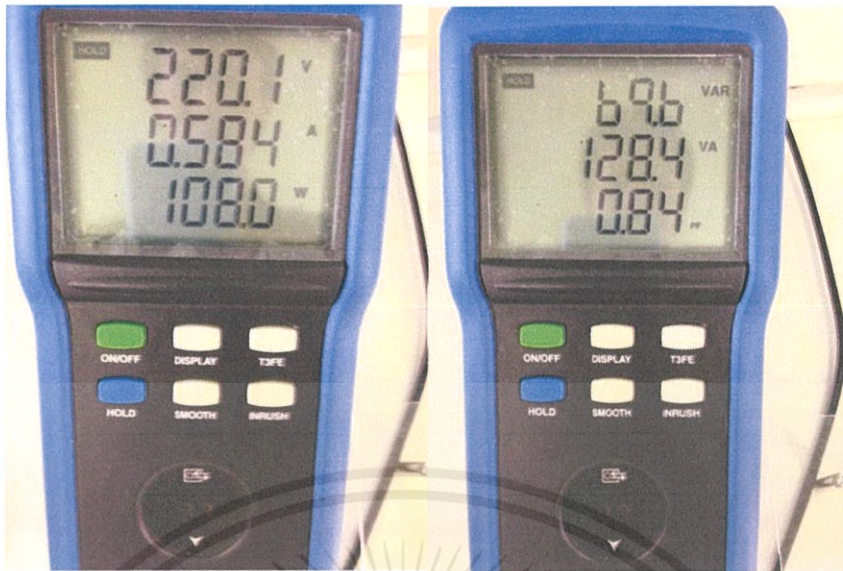
รูปที่ 4.11 ผลการทดลองที่วัดได้ขณะมีการต่อตัวเก็บประจุ 27 ไมโครฟารัด
