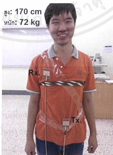
รูปที่ 4.19 ตัวอย่างตำแหน่งของสายอากาศตัวรับและตัวส่งบนร่างกายมนุษย์
