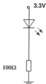
รูปที่ 3.4 วงจรภาคส่งของเซนเซอร์อินฟราเรด
