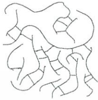
รูปที่ 2.2 โครงสร้างพอลิเมอร์แบบร่างแหหรือแบบเชื่อมขวาง [2]
