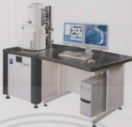
รูปที่ ค.1 กล้องจุลทรรศน์อิเล็กตรอนชนิดส่องผ่าน (SEM) รุ่น EVO ® MA 10 Versatile multipurpose SEM [21]
