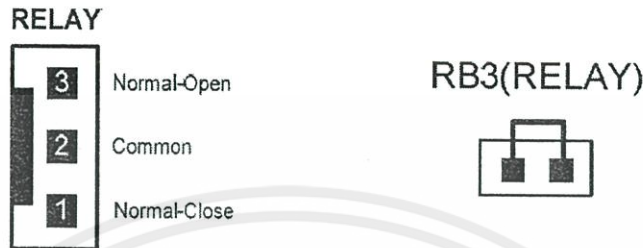
รูปแสดง ลักษณะขั้วต่อสัญญาณจากหน้าสัมผัสของ RELAY
