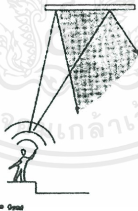
ภาพที่ 7.37 แสดงรูปแบบการติดตั้งวัสดุช่วยในการสะท้อนเสียงของแผ่นเรียบ
