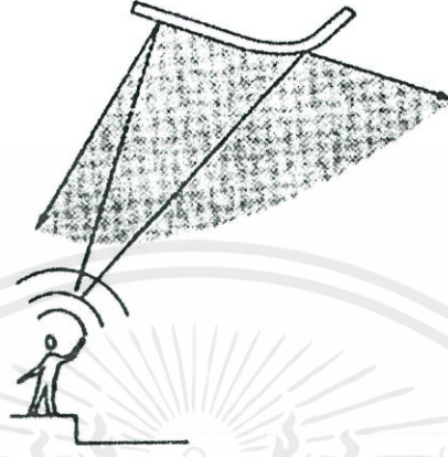
ภาพที่ 7.36 แสดงรูปแบบการติดตั้งวัสดุช่วยในการสะท้อนเสียงของแผ่นโค้งเว้า
