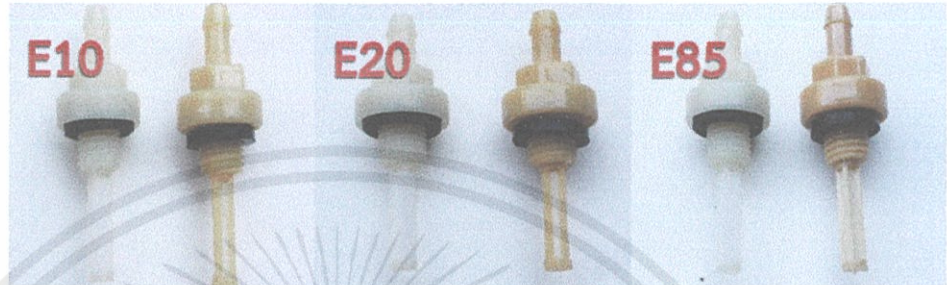
รูปที่ 5.3 การเปลี่ยนแปลงสีของ Fuel filter ในแก๊สโซฮอล์อี 10, อี 20 และ อี85
