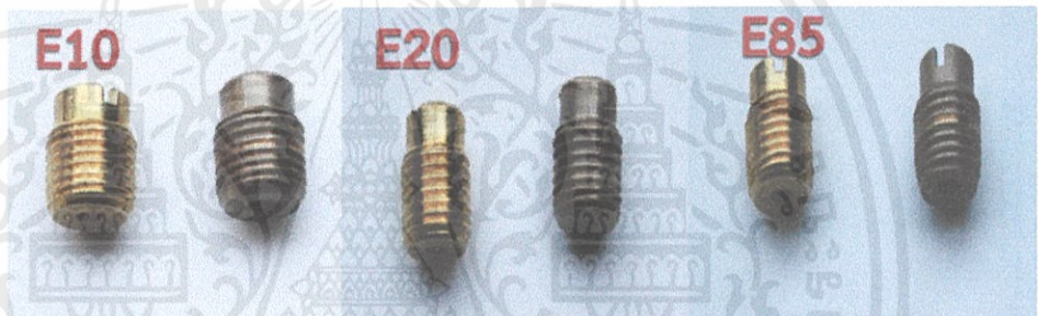
รูปที่ 5.4 การเปลี่ยนแปลงสีของ Main Jet ในแก๊สโซฮอล์อี 10, อี 20 และ อี85
