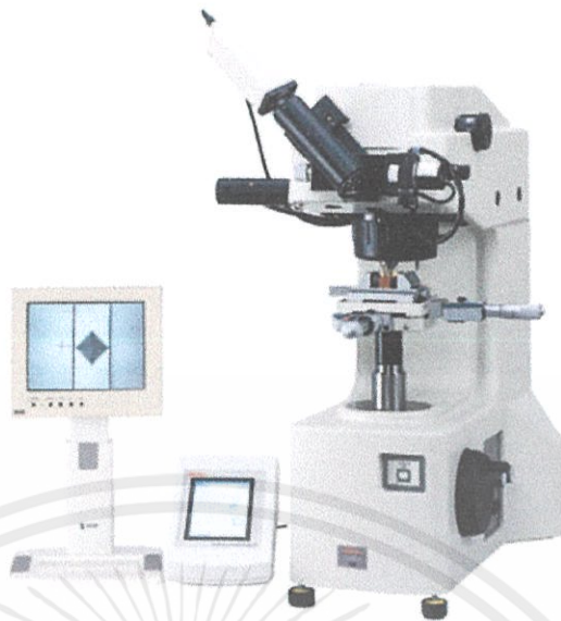
รูปที่ 2.2ก แสดงเครื่องวัดความแข็ง MITUTOYO HM-113 Micro-Vickers Hardness Testing
