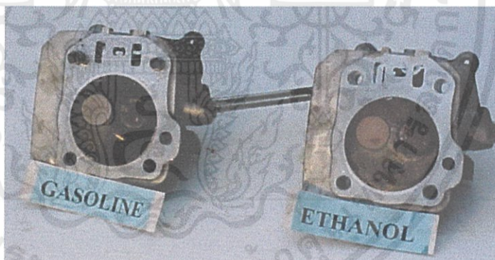
รูปที่ 2.3 ลักษณะของฝาสูบของเครื่องยนต์เอทานอลและเครื่องยนต์แก๊สโซลีนหลังการทดสอบ
