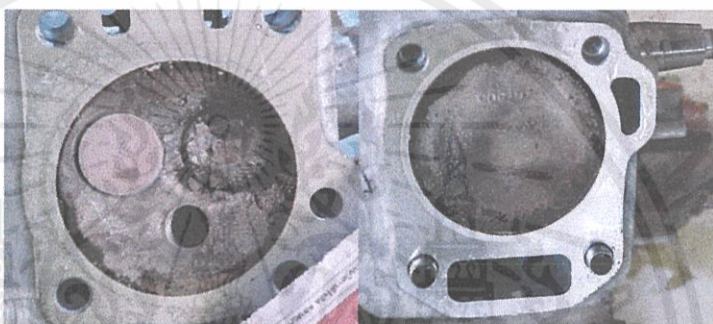
รูปที่ 2.2 ลักษณะของฝาสูบและลูกสูบของเครื่องยนต์เอทานอล หลังการทดสอบ
