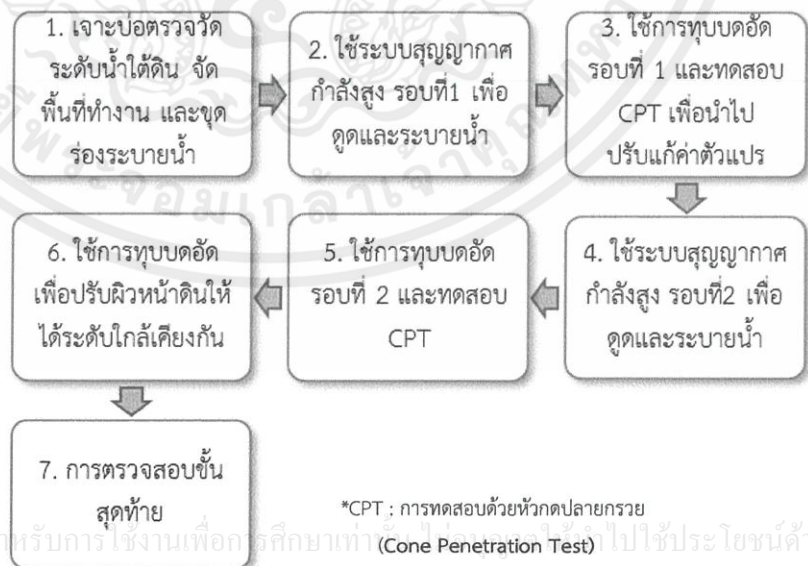
รูปที่ 3.32 ผังระบบการทำงานของเทคนิค HVDM (Liang and Xu, 2010)
