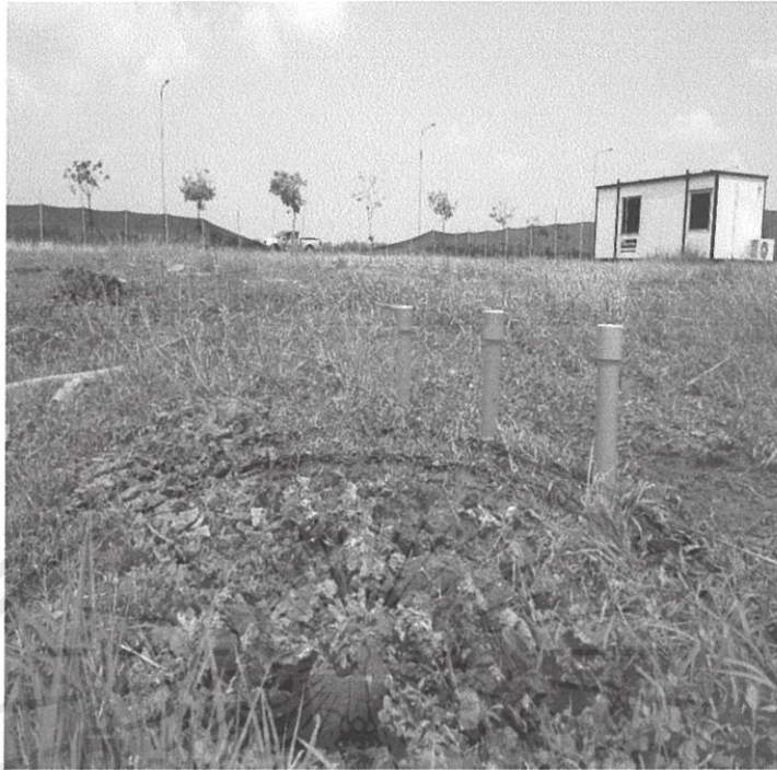
รูปที่ 3.27 การติดตั้ง Piezometer ในสนาม
