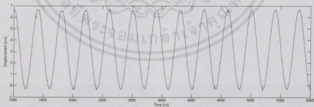
กราฟที่ 5.ข แสดงความสัมพันธ์ระยะชักของกระบอกสูบกับเวลาของระบบปิดควบคุมด้วยวาล์วควบคุมอัตราการไหล โดยใช้ PI Controller ร่วมกับ Feedforward
