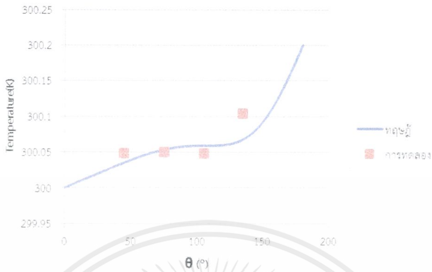
รูปที่ 4-21 กราฟการกระจายอุณหภูมิต่ออุณหภูมิ แสดงความสัมพันธ์ระหว่าง อุณหภูมิในเคลวินและมุมของ แบร์ริงที่ความเร็วรอบ 507รอบต่อนาที และภาระ 10กิโลกรัม (อัตราส่วนความเยื้องศูนย์กลาง=0.107)
