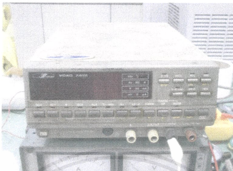
รูปที่ 3-16 โวลมิเตอร์ (Volt meter)
