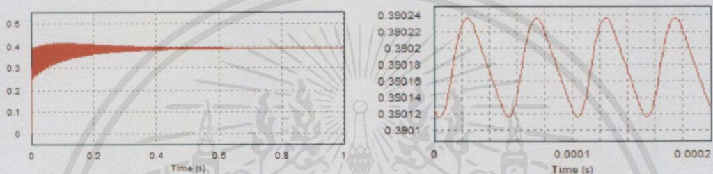
รูปที่ 4.24 ผลการจำลองกระแสที่ด้านออก(ซ้าย) และริบเบิลของกระแสที่ด้านออก(ขวา) ที่แรงดัน 36 โวลต์ ดิวตี้ไซเคิล 26%
