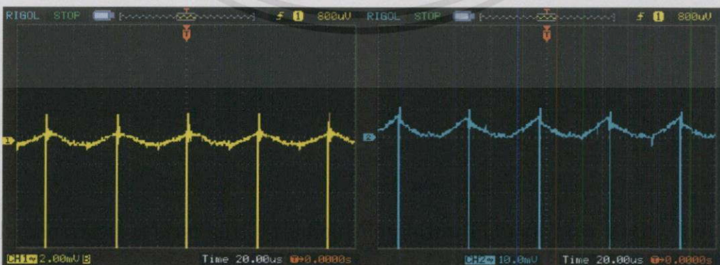
รูปที่ 4.44 กระแสกระเพื่อมด้านออก(ซ้าย) และแรงดันกระเพื่อมด้านออก(ขวา) ที่แรงดันขาเข้า 24 V
