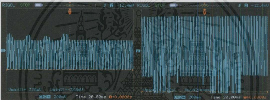
รูปที่ 4.37 กราฟแรงดันขาเข้า (ซ้าย) กราฟแรงดันด้านขาออก (ขวา) ที่แรงดันขาเข้า 10 V
