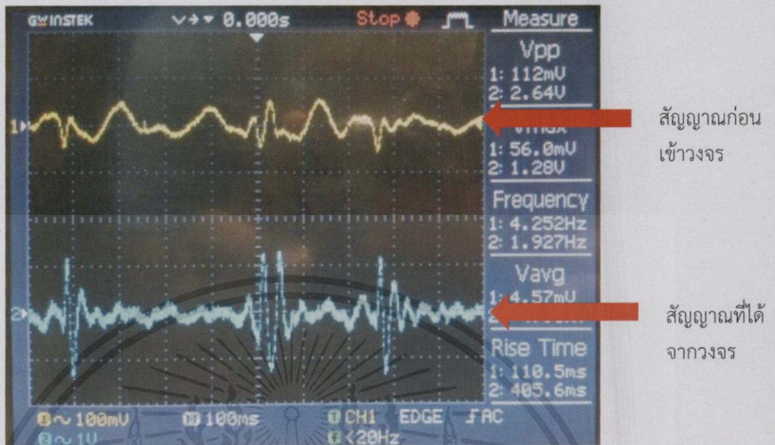
รูปที่ 4.3 กราฟเสียงหัวใจของคนปกติ คนที่ 2
