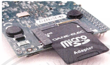
รูปที่ 2.20 นำ SD card มาเสียบบอร์ด Raspberry Pi
