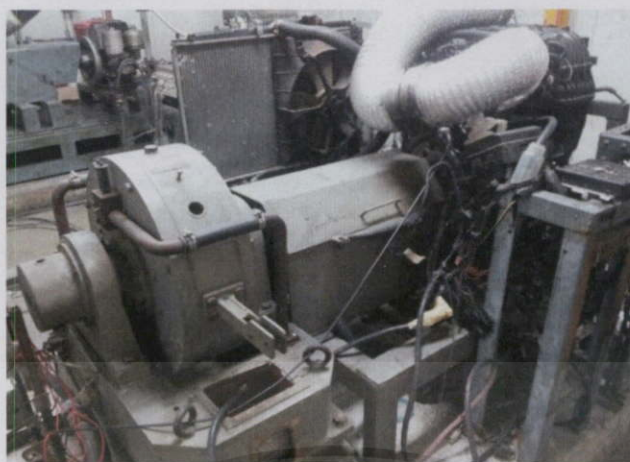
รูปที่ 3.2 แสดง Engine Dynamometer รุ่น Tokyo Plant 150PS ที่ใช้ในการทดลอง
