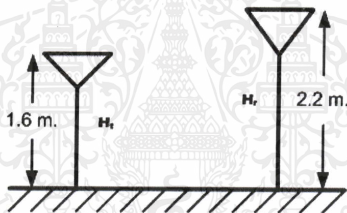
รูปที่ 4.19 การปรับความสูงของสายอากาศด้านส่งและด้านรับให้มีค่า 1.6 เมตร และ 2.2 เมตร ตามลำดับ
