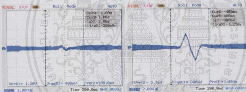
รูปที่ 4.2 ตัวอย่างสัญญาณเอาต์พุตที่ระยะห่าง 10 mm (ซ้าย) และ 5 mm (ขวา)
