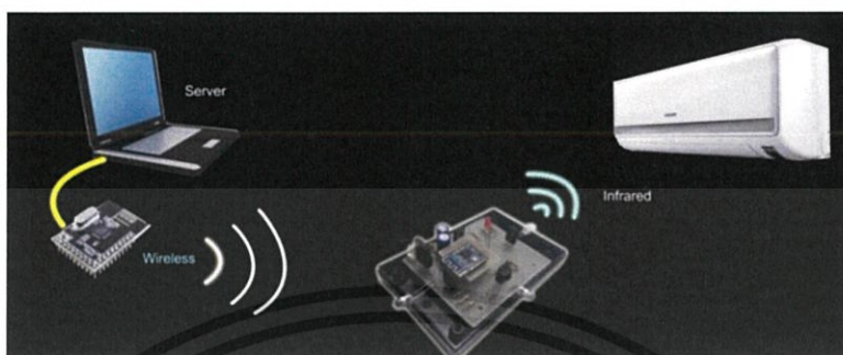
รูปที่ 4.3 ลักษณะการส่งสัญญาณอินฟราเรดควบคุมเครื่องปรับอากาศ
