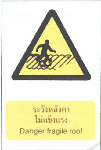
รูปที่ 4-23 ระวังหลังคาไม่แข็งแรง
