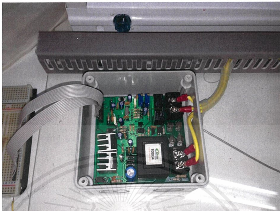
รูปที่ 4.1.2 บอร์ดวงจรที่ใช้ในการควบคุมการเปิด - ปิด หลอดไฟ
