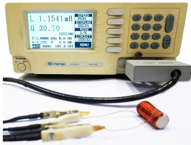
รูปที่ 3.13 แสดงเครื่องมือวัดค่า LCR หรือ LCR Meter
