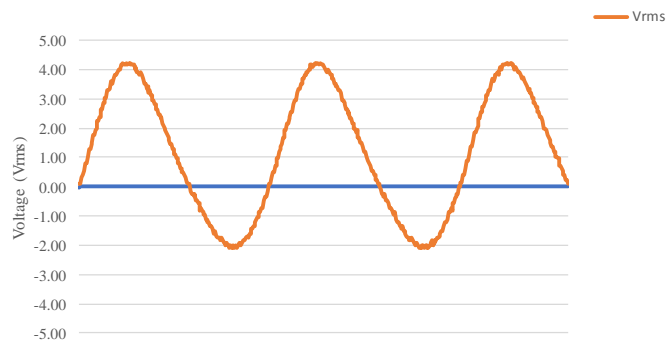
รูปที่ 3.6 แสดงรูปคลื่นแรงดันไฟฟ้าเฉลี่ยจาก Class-A amplifier
