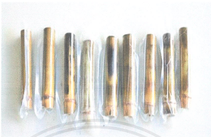
รูปที่ ค.3 กระบอกไม้ไผ่หลังผ่านการสเตอริไลซ์
