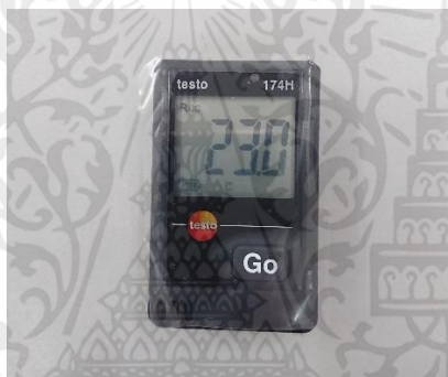
ภาพที่ 4.7 แสดงตัวอย่างอุปกรณ์ Testo 174H ก่อนนำขึ้นไปติดตั้งในห้องทดสอบที่มา : ผู้วิจัย (บันทึกภาพวันที่ 25 มิ.ย.62)
