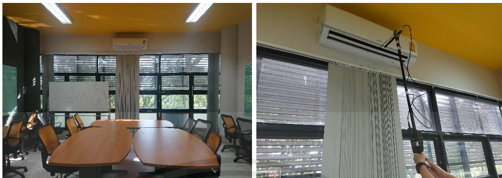
ภาพที่ 4.3 แสดงการเตรียมห้องสำหรับทดสอบและการวัดค่าเพื่อประเมินค่าประสิทธิภาพพลังงาน(EER)จากการใช้งานจริง ตามลำดับ ที่มา : ผู้วิจัย
