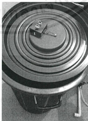
รูปที่ 4.5 แสดงตำแหน่งของอัลตราโซนิกเซนเซอร์ในถังน้ำ ใบเล็ก (ซ้าย) และใบใหญ่ (ขวา)
