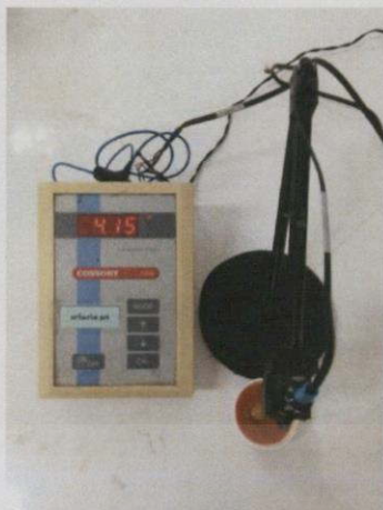
รูปที่ ข.11 เครื่องวัดค่าความเป็นกรด-ด่าง
