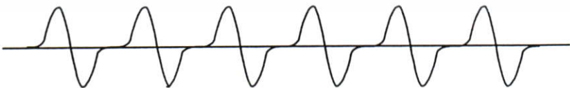
รูปที่ 2.8 แสดงรูปคลื่นกระแสอินรัชทรานเซียนต์ที่เกิดขึ้นในขดหนึ่งของการต่อแบบเดลต้า หรือ ด้านทุติยภูมิของการต่อแบบเดลต้าในหม้อแปลงกระแส
