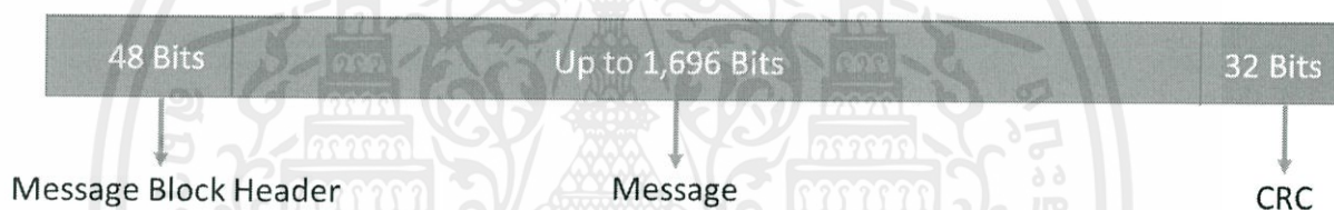
รูปที่ 2.6 รายละเอียดเฟรมข้อมูลของ Type-1
