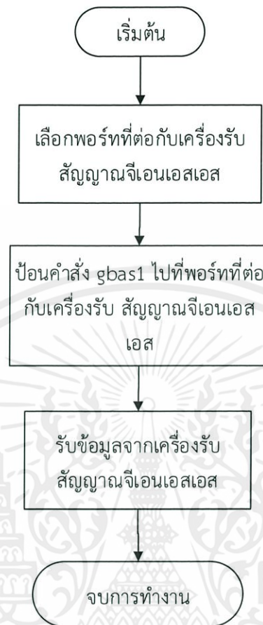
รูปที่ 3.5 แผนภาพการทำงานของส่วนการป้อนคำสั่งให้เครื่องรับสัญญาณจีเอ็นเอสเอสและรับข้อมูลสำหรับเครื่องรับสัญญาณจีเอ็นเอสเอสรุ่น NovAtel OEMV-3 with DL-V3 enclosure
