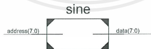
รูปที่ 4.39 วงจรกำเนิดสัญญาณพาหะ (Digital Oscillator)
