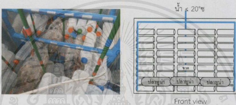
รูปที่ 4.7 การจัดวางขวดน้ำและพลาสติกแช่แข็งภายในถังละลาย
