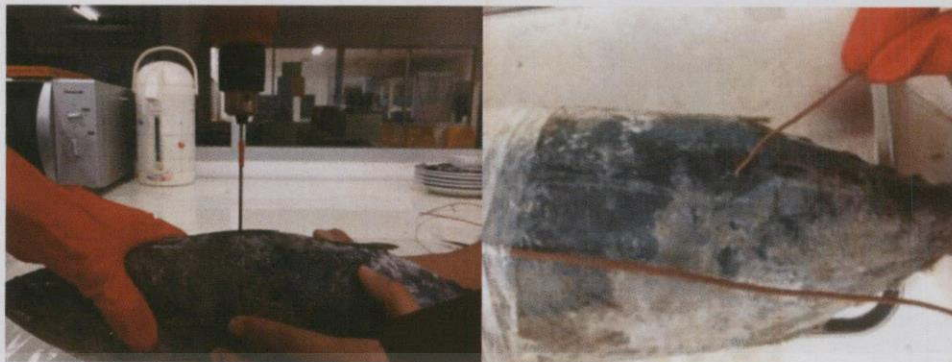
รูปที่ 4.3 การเจาะและการเสียบสายเทอร์โมคัลเปิดเพื่อวัดอุณหภูมิปลาทUNA
