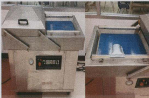
รูปที่ 3.6 การปิดผนึกสนิทด้วยเครื่องปิดผนึกสูญญากาศ
