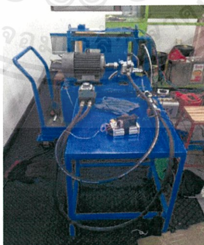
รูปที่ 3.9 ชุดทดสอบสมรรถนะน้ำมันปาล์มและประสิทธิภาพของปั๊มไฮดรอลิก
