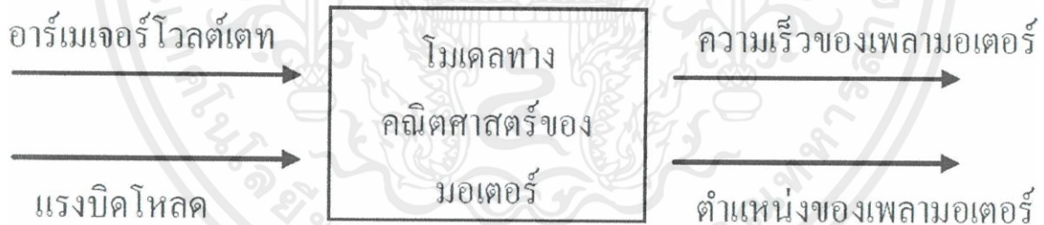
ภาพที่ 2.3 แสดงอินพุตและเอาต์พุตของโมเดลทางคณิตศาสตร์ของมอเตอร์
