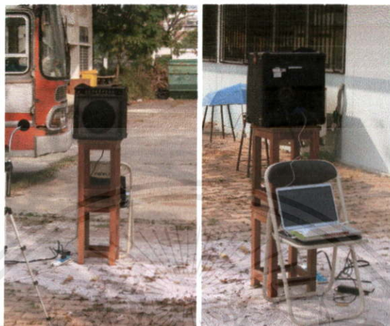
รูปที่ 3.14 การตั้งเครื่องกำเนิดเสียง
