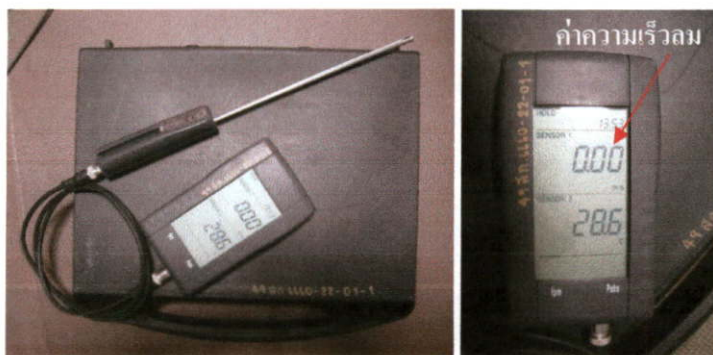
รูปที่ 3.4 แสดงการใช้งานเครื่องมือวัดความเร็วลม
