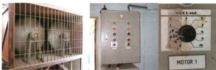
รูปที่ 3.2 พัดลม ก่อตั้งควบคุมความเร็วพัดลม และการตั้งค่าความเร็วของพัดลมเพื่อใช้ในการทดลอง
